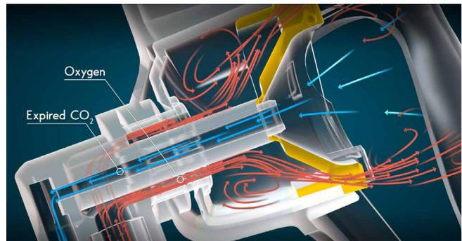
Innenansicht des aktualisierten Diffusor- und Prallplatten-Designs mit Richtungselementen an den Diffusorscheitelpunkten (pink); es zeigt den Fluss konzentrierter Sauerstoffwirbel, die aus den aerodynamischen Richtungselementen absichtlich in Richtung Nase und Mund strömen, und EtCO<sub>2</sub>, das in den pilzförmigen Becher und die Probenleitung hinunter fließt, selbst bei höheren Sauerstoffflüssen.
